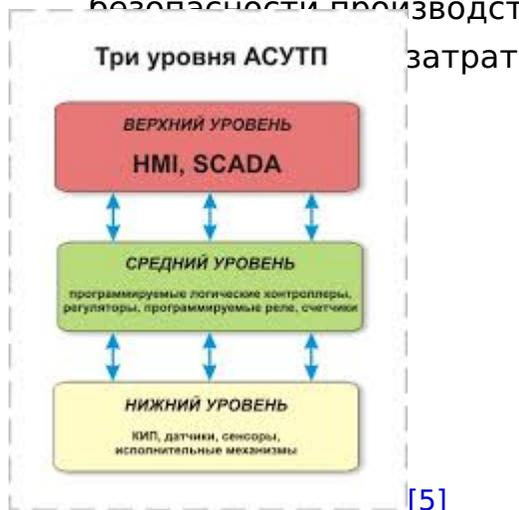
**SCADA** (аббр. от англ. **S**upervisory **C**ontrol **A**nd **D**ata **A**cquisition — диспетчерское управление и сбор данных) — программный пакет, предназначенный для разработки или обеспечения работы в реальном времени систем сбора, обработки, отображения и архивирования информации об объекте мониторинга или управления.
